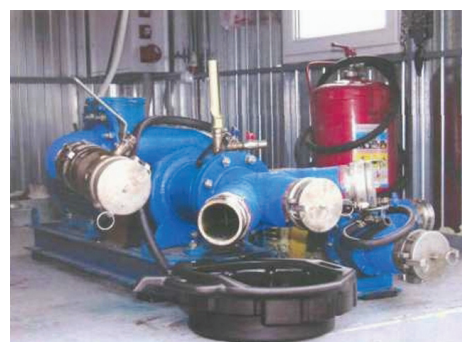
Рис. 1. Набор коммутационной и запорно-вентильной арматуры, предназначенный для подключения оседагональной насосной установки УОДН 290-150-125
